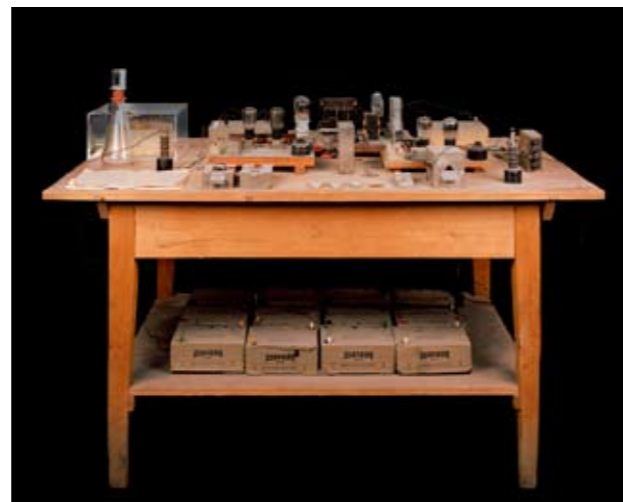
Prof. Otto Hahn's Work Table for Neutron Bombardment of Uranium, 1938, Deutsches Museum Setup, München , bois, verre, miroirs, dispositifs, panneaux lumineux LED, 344 x 1300 x 600 mm, 2010. Ce stéréographe montre une image tridimensionnelle de la table expérimentale sur laquelle O. Hahn étudia la transmutation de l'uranium sous irradiation de neutrons, en 1938 à Berlin, l'année où Majorana disparaissait. Lise Meitner, une chimiste d'origine juive en exil en Suède pour fuir les nazis, donna l'interprétation correcte de cette expérience cardinale: sous bombardement neutronique, le noyau d'uranium se scindait en deux. La fission de l'uranium est la réaction de base des bombes atomiques.
